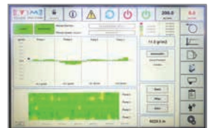
Sterowanie według gramatury w systemie Weight-Inspekt z pętlą zamkniętą
