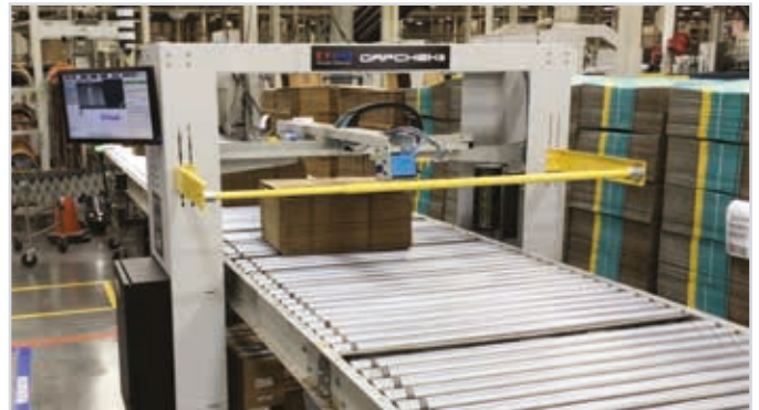
Montaż na istniejącym przenośniku płaskim lub rolkowym
